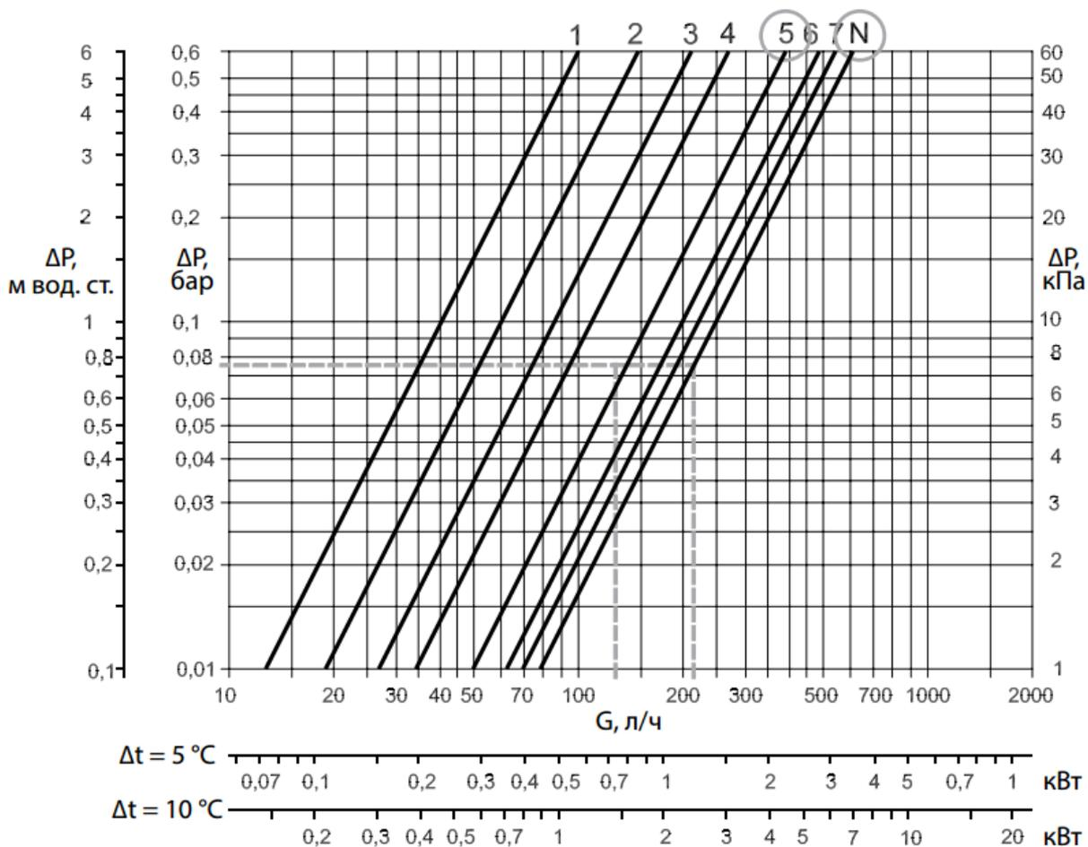
Диаграмма пропускной способности показывает зависимость расхода теплоносителя от перепада давлений и значения предварительной настройки встроенных клапанов.
