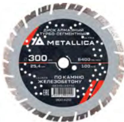
Тело диска изготовлено из пружинной стали 65Г. Высокая концентрация синтетических алмазных зерен в металлической связке. Металлическая связка сегмента средней твердости, для увеличения скорости и производительности работы с железобетонном и широким спектром общестроительных материалов. Турбированный алмазный сегмент обеспечивает лучшее охлаждение и выброс шлама из пропила при высокой скорости подачи. Узкие слоты предохраняют диск от повреждения при попадании в арматуру.
