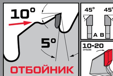
Для предотвращения растрескивания напаяк при попадании на препятствие, напайки изготовлены из мелкозернистого карбида Вольфрама марки P40 пониженной до 88-89HRA твердости. Сплав содержит карбиды Титана и Тантала и до 11,5% мягкой легирующей добавки - Кобальта. Специальная технология медленной алмазной заточки зуба Long Time позволяет получить оптимальную поверхностную структуру режущей кромки.
