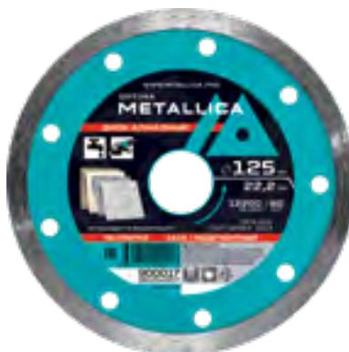
Изготовлены методом прессования с последующим спеканием в вакуумной печи. Тело диска изготовлено из пружинной стали 65Г. Металлическая связка алмазного слоя достаточно твердая, для увеличения ресурса при работе по мягким материалам и материалам средней твердости. Использовать охлаждение водой. Не подходят для керамогранита. Упакованы в термоусадочную пленку по 5 штук. Артикул - 1 штука.
