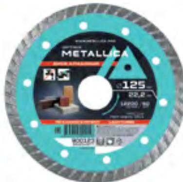
Тело диска изготовлено из пружинной стали 65Г. Металлическая связка сегмента средней твердости, для увеличения скорости при работе по общестроительным материалам. Турбированный алмазный слой обеспечивает хорошее качество кромки при высокой скорости подачи. Сухой рез. Охлаждение водой продлевает ресурс диска. Не подходит для гранита. При пилении абразивных материалов существенно сокращается ресурс диска. Упакованы в термоусадочную пленку по 5 штук. Артикул - 1 штука.
