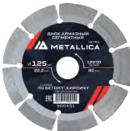
Тело диска изготовлено из пружинной стали 65Г. Сегменты изготовлены по специальной технологии PDA-patterned diamond arraying technology. Широкие слоты для эффективного удаления шлама из пропила. Сухой рез. Охлаждение водой продлевает ресурс диска. Не подходит для гранита. При пилении абразивных материалов сокращается ресурс диска.
