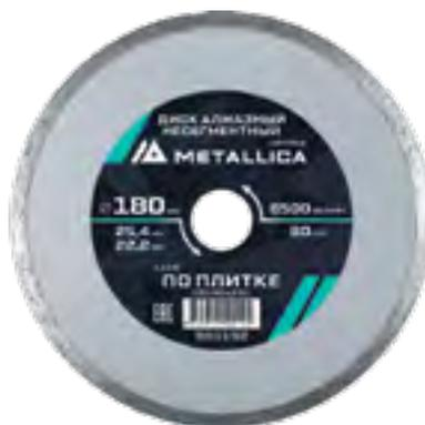
Изготовлен методом прессования с последующим спеканием в вакуумной печи. Тело диска изготовлено из пружинной стали 65Г. Высокая концентрация синтетических алмазных зерен в металлической связке. Металлическая связка сегмента твердая, для увеличения ресурса при работе по мягким материалам и материалам средней твердости. Использовать охлаждение водой. Не подходят для керамогранита. Поставляются в индивидуальной упаковке.
