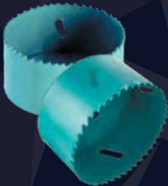
Полотно коронки характеризуется повышенной вязкостью, высокой сопротивляемостью износу, пониженной шлифуемостью. Режущая часть имеет волнистый профиль для последовательного срезания слоя материала, то есть для минимизации нагрузки на зуб при сверлении сталей и других металлов с высоким сопротивлением на разрыв. Тип режущего полотна Vario - с переменным шагом зубов, для лучшего выбрасывания опилок и снижения вероятности заклинивания при сверлении тонких материалов.
