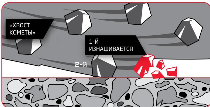
Срезая материал, рабочие кристаллы изнашиваются и разрушаются, из связки вскрываются новые кристаллы. Если происходит преждевременный износ рабочих кристаллов, до вскрытия новых из-за недостаточной эрозии связки, появляется эффект «замыливания» диска. Внешне работоспособный диск перестает резать.
