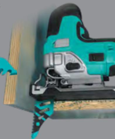
Пилка T142HB специальная широкая предназначена для точного прямолинейного пиления под заранее заданным углом. Позволяет подвести пропил вплотную к стене/преграде заподлицо. Рамочная конструкция снижает трение, сберегая энергию при использовании аккумуляторного лобзика. Особенно подходит для пиления элементов мебели, дверных коробок, подоконников, наличников. Скорость пиления высокая. Качество кромки по обратной стороне выше, чем по лицевой.
