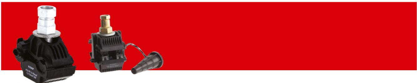
Зажимы прокалывающие ответвительные предназначены для герметичного соединения и ответвления изолированных абонентских проводов и проводов освещения. При затягивании болта со срывной головкой зубцы контактных пластин прорезают изоляцию и входят в зацепление с проводником, образуя надежное соединение с
