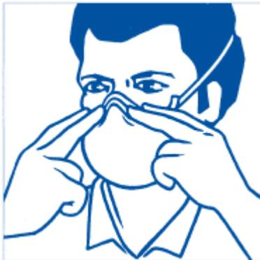
4. Расположите пальцы обеих рук на верху металлической носовой части. Изогните носовую часть по форме своего носа, равномерно с обеих сторон сдвигая пальцами носовую часть вниз. Выполнение этой операции одной рукой может привести к снижению защитных характеристик Полумаски фильтрующей для защиты от аэрозолей.
