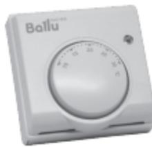
Термостатический механический ВМТ-1 применяется для регулирования поддерживаемой в помещении температуры. В качестве чувствительного элемента используется сильфон, заполненный газом. Обычно применяется в коммерческих приложениях, в домашних системах отопления и кондиционирования воздуха.
