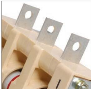
Контактные выводы, выполненные из высококачественной электротехнической меди с нанесенным защитным покрытием, позволяют присоединять медные и алюминиевые токопроводящие жилы, оконцованные кабельными наконечниками, а также медные и алюминиевые шины.
