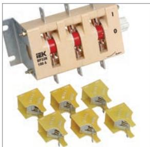
Дугогасительные камеры, большой раствор контактов, двойной разрыв цепи обеспечивают эффективное гашение электрической дуги при коммутации нагрузок, что снижает износ контактов.
