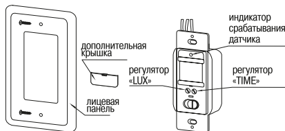
Рисунок 11 – Конструкция датчика движения ДД-028
