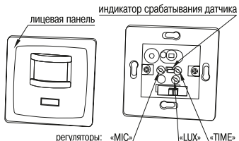
Рисунок 15 – Конструкция датчика движения ДД-035
