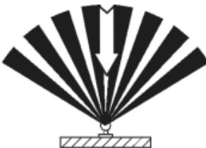
ния датчика объекты, которые могут приводить к его ошибочным срабатываниям. Для этого необходимо избегать установки датчика вблизи зон температурного возмущения (кондиционер, отопление) и вентиляторов.
