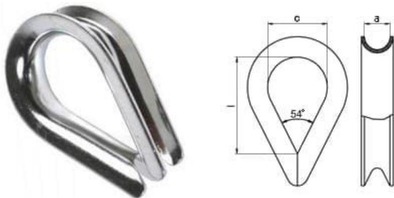
DIN 6899 коуш оцинкованной стальной для троса, каната. Коуш вставляется в петлю троса, каната для предохранения от истирания и излома. Коуши DIN 6899 могут быть установлены как на стальные, так и на растительные и синтетические канаты. Размер коуша определяется диаметром троса от 3 до 34 мм.
