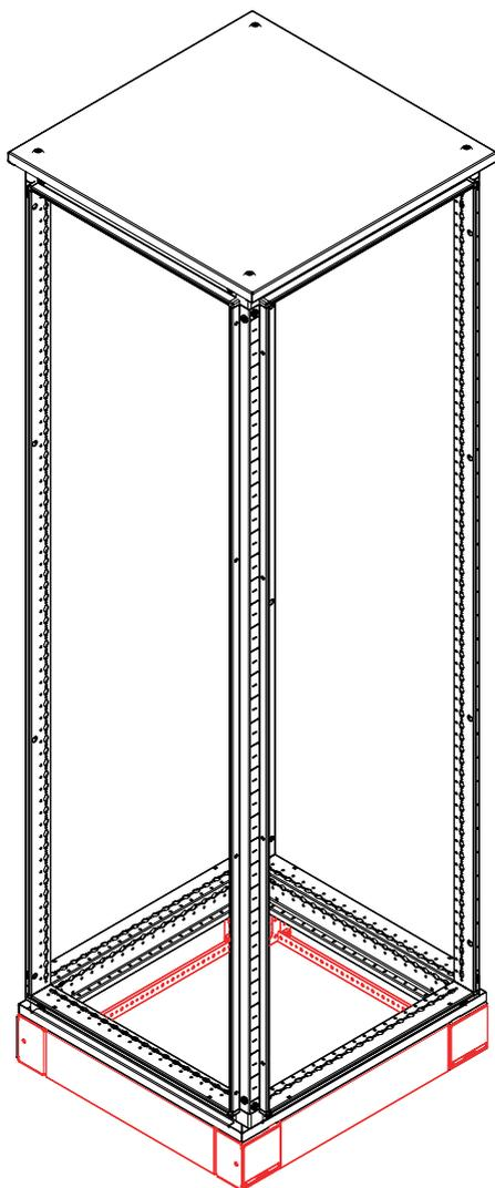
Установка комплекта фланцев цоколя R5NFP высотой 100 мм
