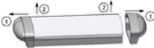
2. Вщелкнуть опору в корпус светильника.
