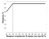
Рисунок 9. График зависимости нагрузочной способности блока питания от входного напряжения.
