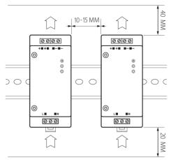
Рисунок 5. Размещение блока питания.
