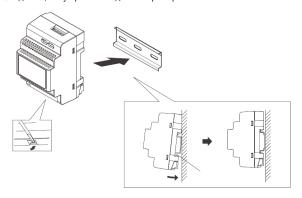
Рисунок 7. Установка блока питания на DIN-рейку.
