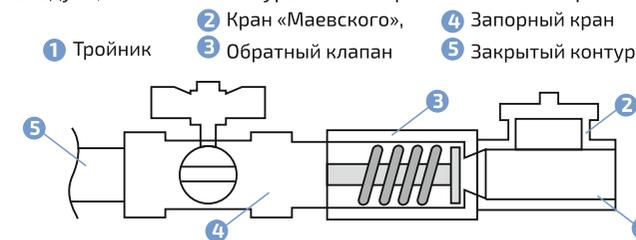
● Подключите насос к контуру, налейте в насос жидкость идентичную той, которой заполнен контур. Запорный кран должен быть закрыт. Поднимите насосом небольшое давление, приоткрывая кран «Маевского» стравите воздух. При необходимости повторите процедуру несколько раз, чтобы в систему не попал воздух. Когда воздуха не останется. Насосом выравняйте давление в контуре и в насосе. Плавно откройте запорный кран.
