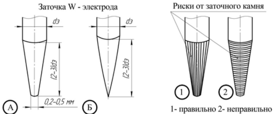
Рис. 8.4. Пример заточки вольфрамового электрода:
