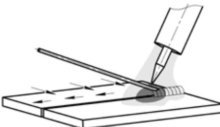
Рис. 8.6. Пример манипуляции присадочной проволокой при TIG сварке.
