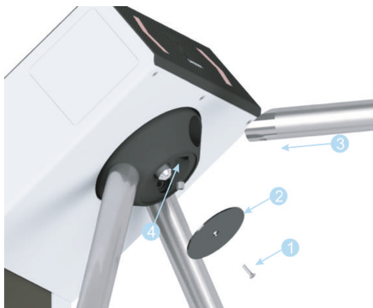
Рисунок 7.5.1 - Установка стандартной преграждающей планки
