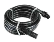
Применяются в качестве входной магистрали поверхностных насосов. Шланги армированы пластиковой спиралью. На одном конце шланга установлен съемный обратный клапан с сетчатым фильтром, на другом конце — разборный соединительный фитинг для соединения с насосом.
