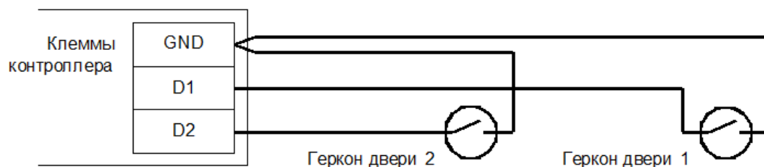
Рис. 35. Подключение датчиков открытия дверей.
