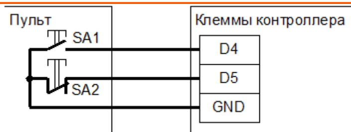
Рис. 63. Пример подключения пульта ручного управления шлагбаумом/воротами к контроллеру, кнопка «Стоп» нормально замкнута.
