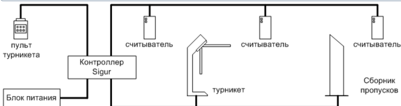
Рис. 42. Пример подключения турникета с картоприёмником.
