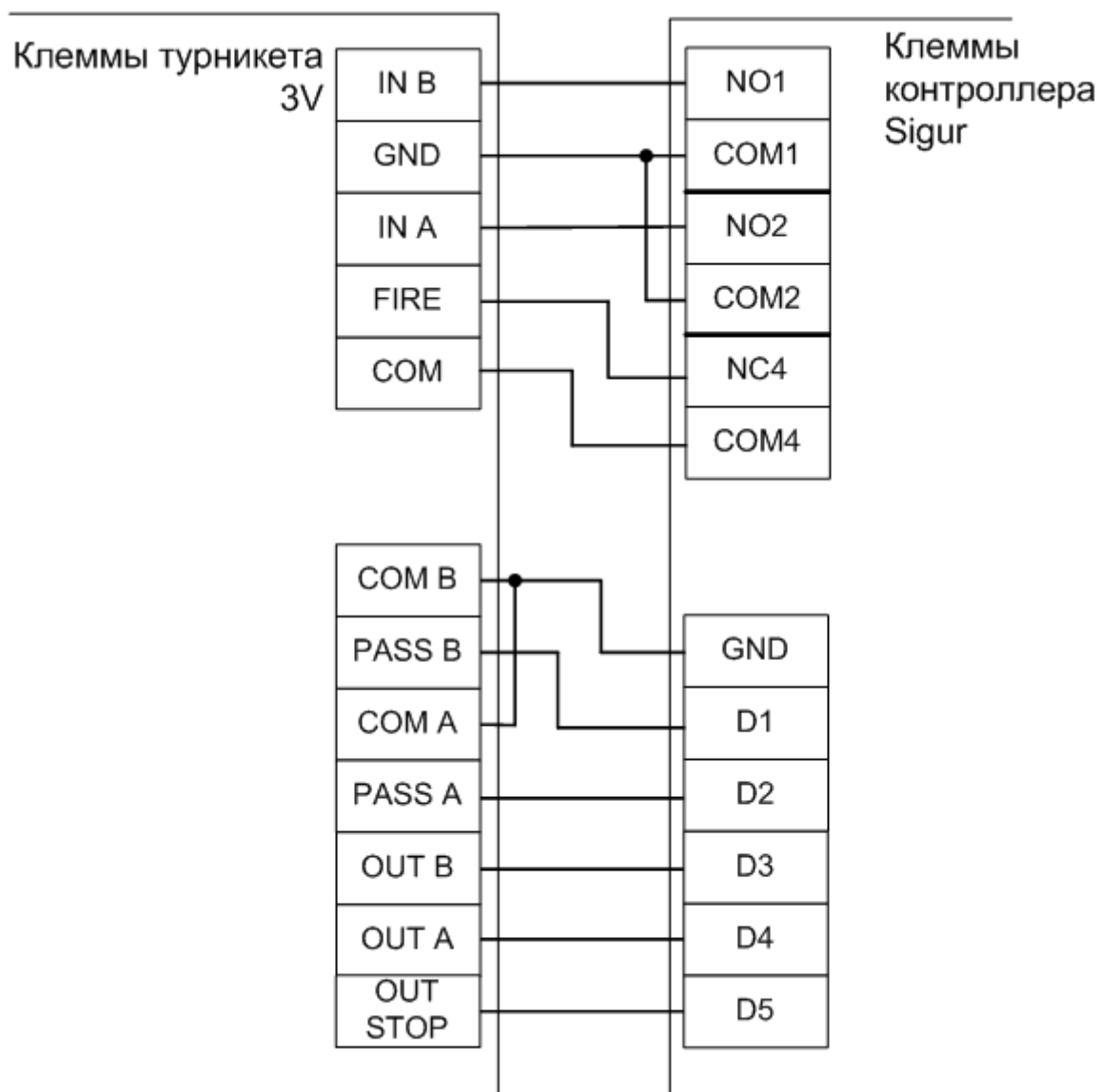
Рис. 52. Подключение турникета 3V к контроллеру с помощью разъёмов на лицевой стороне платы управления турникета.
