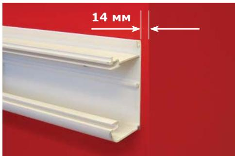
Закрепите кабель-канал на расстоянии 14 мм от угла стены (используйте базу угла как шаблон)
